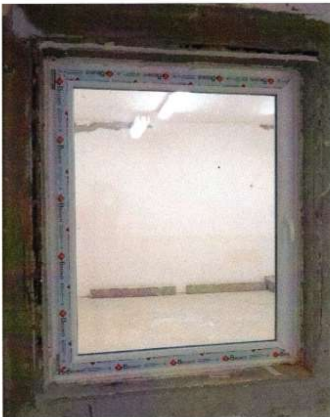
Fotografije ispitnog uzorka iz predajne i prijamne prostorije neposredno prije ispitivanja
