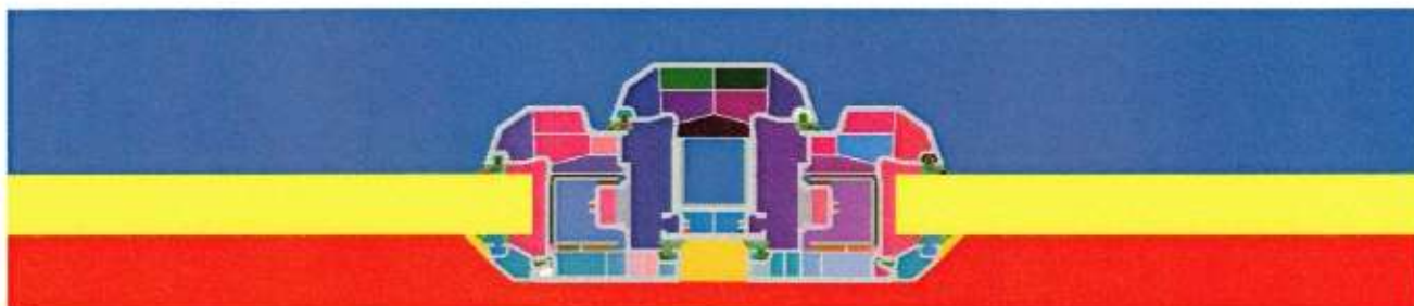
Slika 6: 2-D model za proračun koeficijenta prolaska topline U_f za presjek B-B sustava profila ostakljenog dvostrukim IZO staklom debljine 24 mm. Ukupna širina slike je 5620 piksela (u modelu 562 mm), ukupna visina 1200 piksela (u modelu 120 mm).
