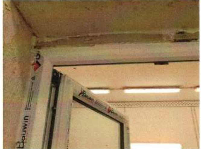
Fotografije detalja ugradnje ispitnog uzorka u ispitnom otvoru
